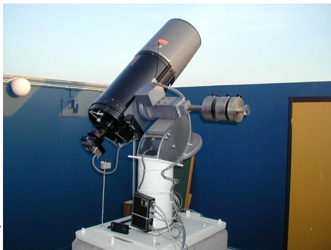
Illustration 3: Teleskopet som användes fäst på stativ och med CCD-kamera tillkopplad i änden Källa: tbobs.se
